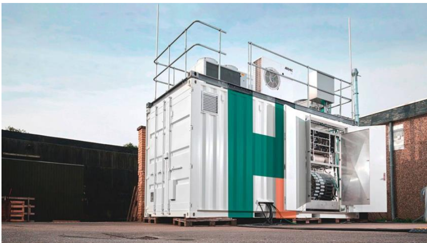
Figur 1: Elektrolyseenhed fra Green Hydrogen System. Teknologien baseres på tryksat alkalisk elektrolyse. På billedet er vist en 20 fods container svarende til ca. 0,45 MW. Modulerne kan skaleres som ønsket.
