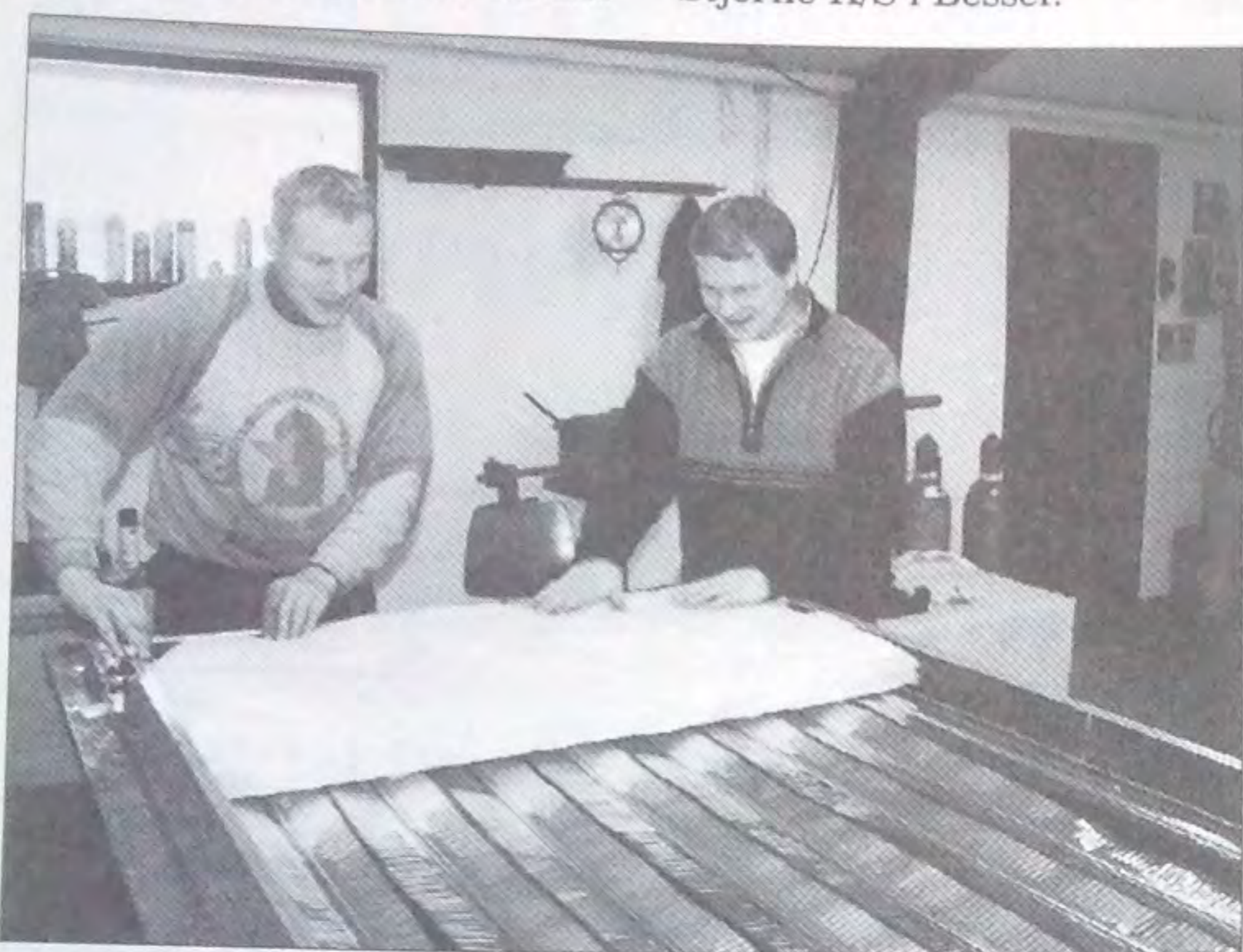
Ole Hemmingsen (til højre) og medhjælperen Jesper Nielsen i færd med at isolere solfangerens bagside.
